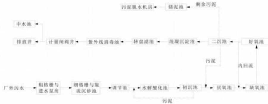
图 6 滨海工业园污水处理有限公司污水处理工艺流程图
