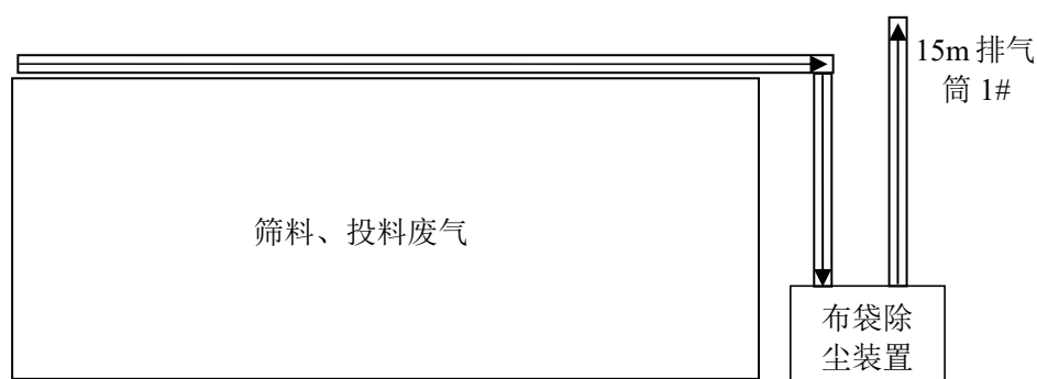
图 7.2-2 筛料、投料废气收集设计示意图
