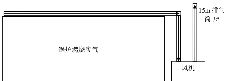
图 7.2-3 锅炉燃烧废气收集设计示意图
