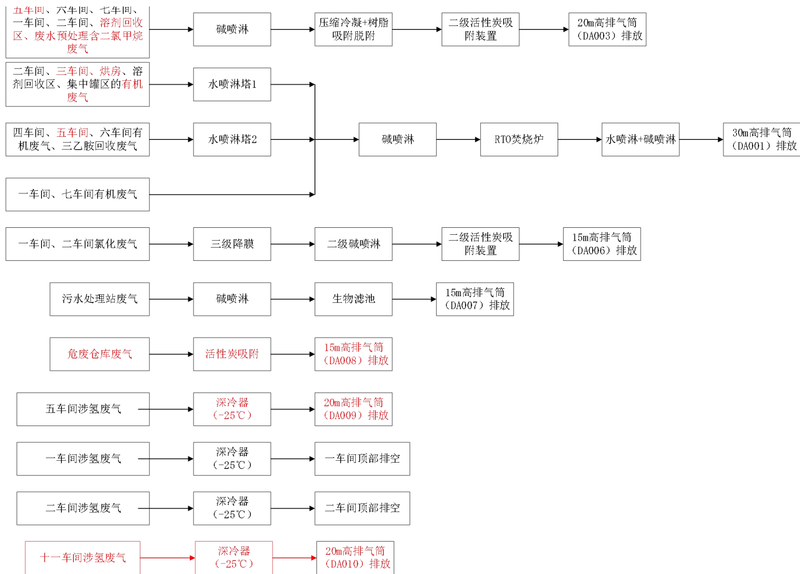
图 7.1-1 本项目建成后全厂废气处理系统示意图
