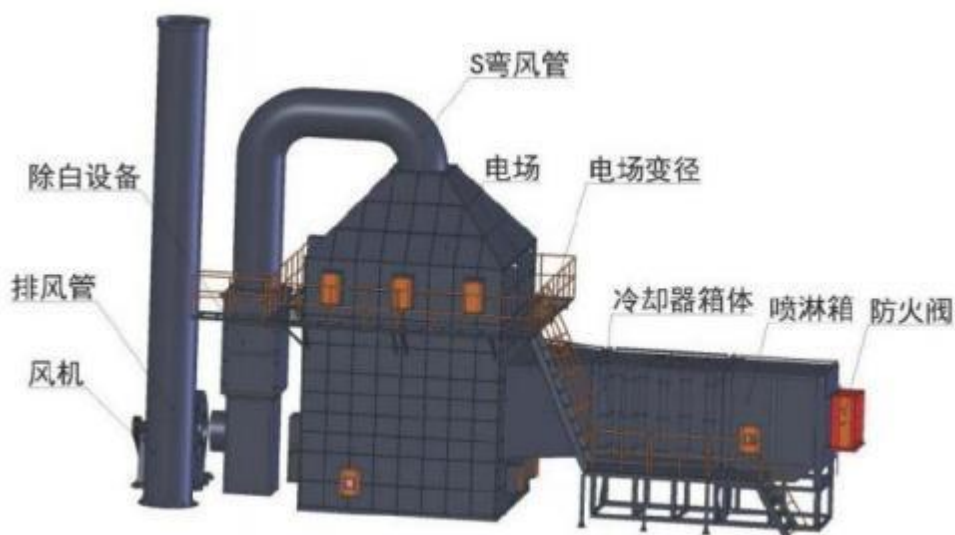
图7.2-5 “水喷淋+静电净化”设备示意图
