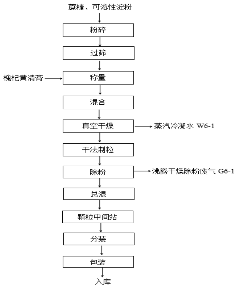
图 2-9 现有项目枸杞黄颗粒生产工艺流程图
