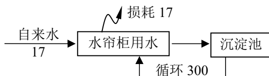
图 5-3 扩建项目用排水平衡图 t/a
