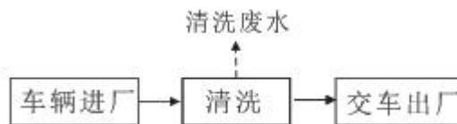
图 5-1.3 汽车清洗工艺流程及产污环节示意
