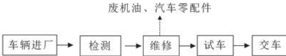
图 5-1.1 汽车一般维修、保养工艺流程及产污环节示意
