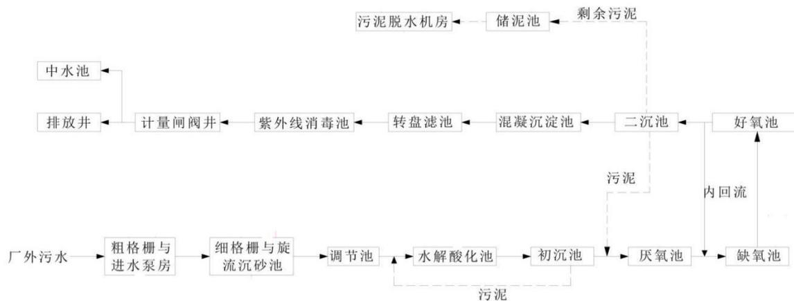
图 4-5 滨海工业园污水处理厂工艺流程图
