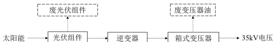
图 4-1 项目运营期光伏发电工艺流程
