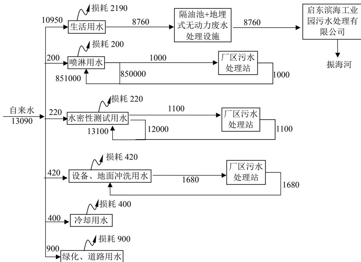
图 2-5 现有项目水平衡图 (t/a)
