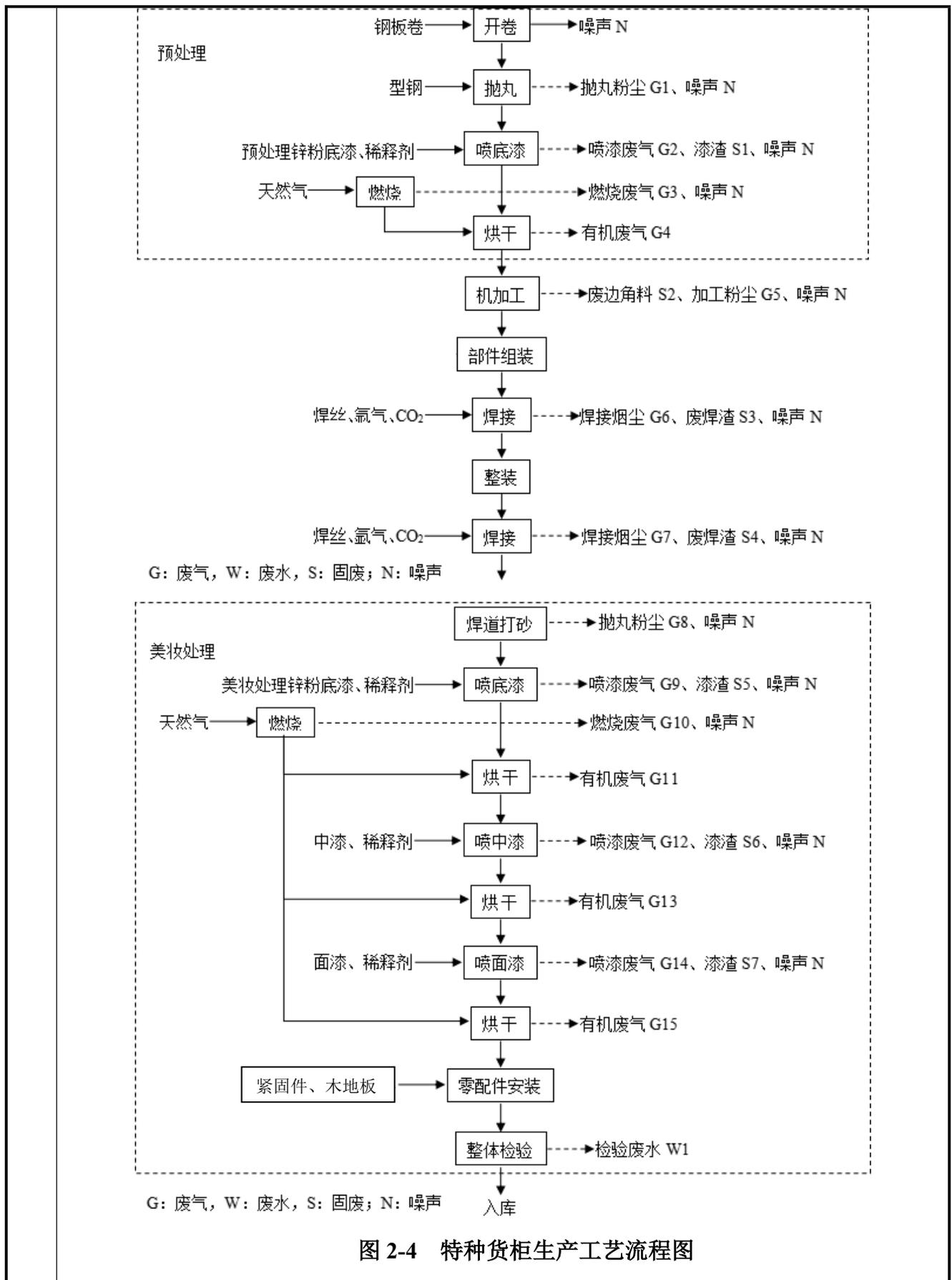
图 2-4 特种货柜生产工艺流程图
