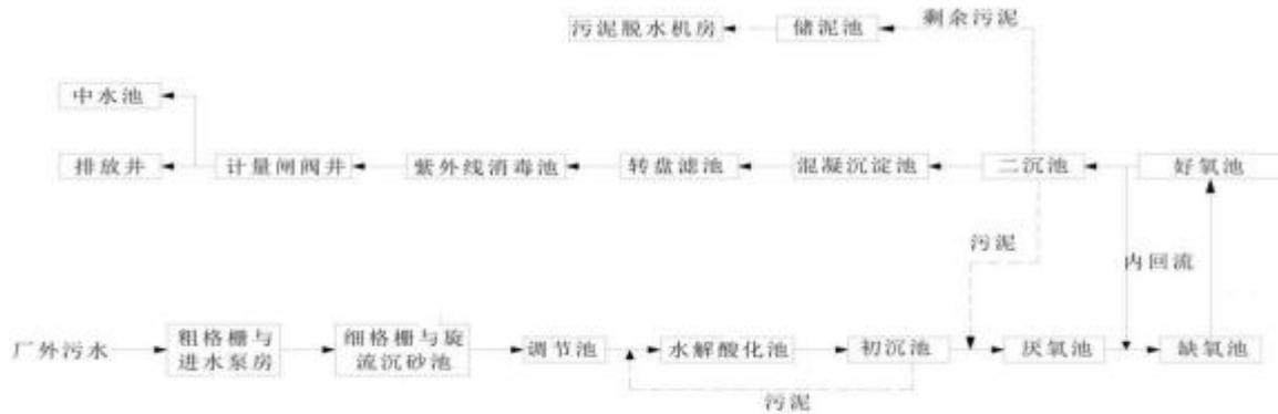
图 4-3 启东滨海工业园污水处理有限公司工艺流程图
