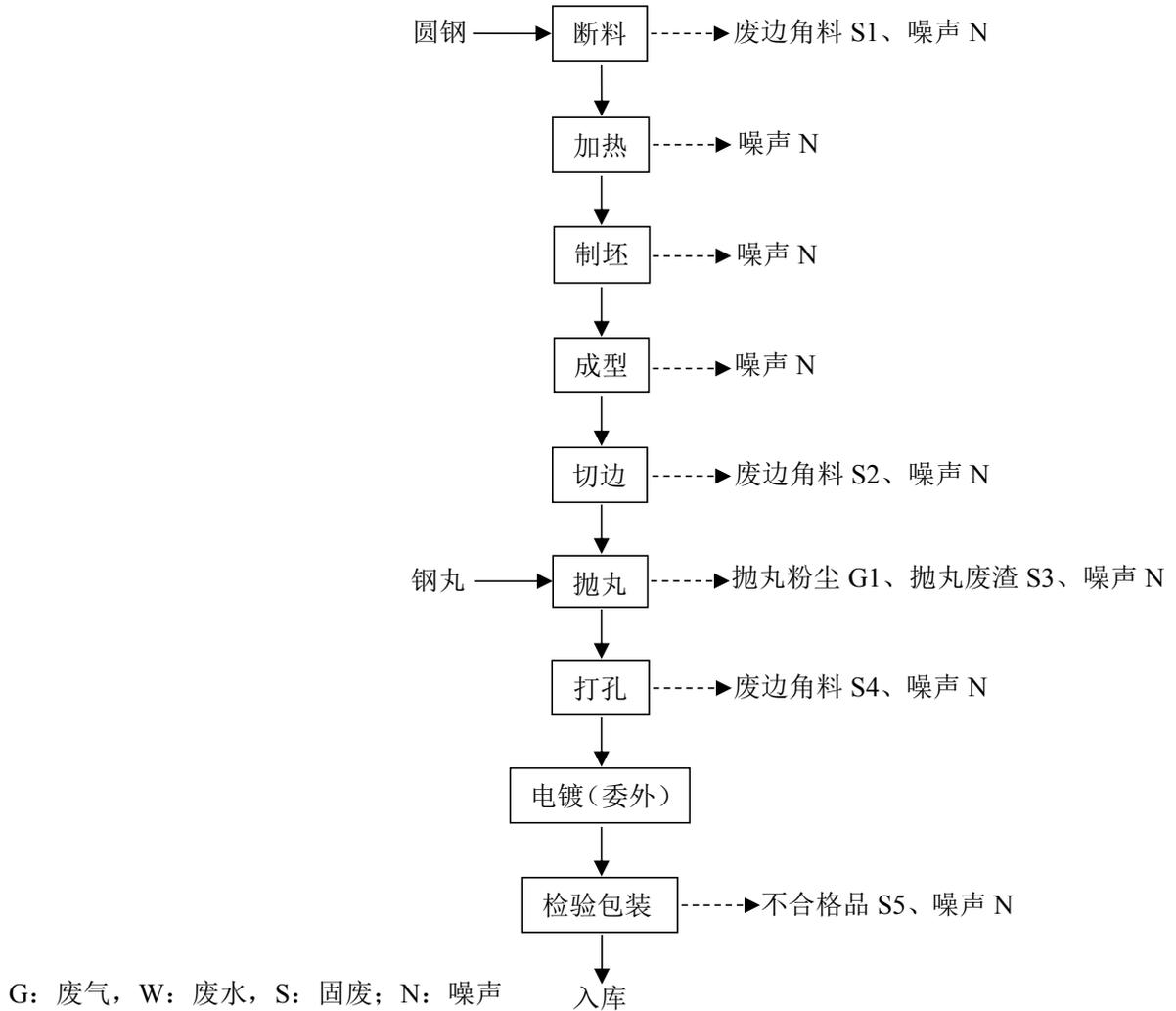
图 2-5 集装箱配件 1 生产工艺流程图
