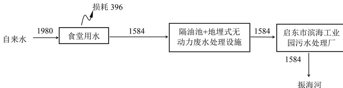
图 2-1 本项目水平衡图 (t/a)
