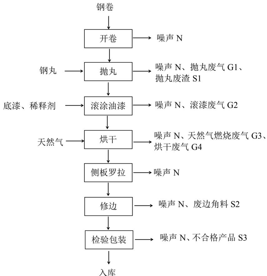
图 2-3 集装箱配件 2 生产工艺流程及产污图
