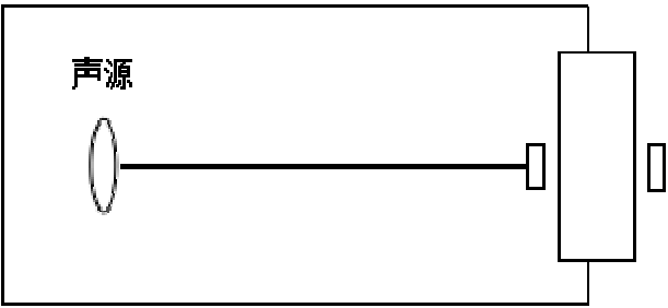
图 4-1 室内声源等效室外声源图例
