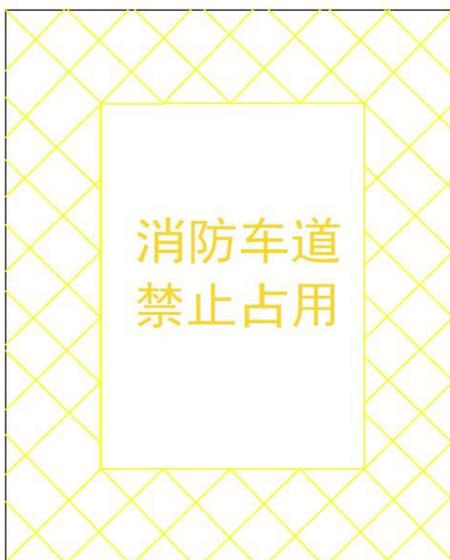
(五) 在消防车通道两侧设置醒目的警示标牌，提示严禁占用消防车通道，违者将承担相应法律责任等内容。警示标牌长宽不小于  $1\text{m} \times 0.6\text{m}$  (若受条件限制，无法满足醒目度要求，应按 5:3 比例加大标志的尺寸)，底边离地高度不低于 1.6m。
